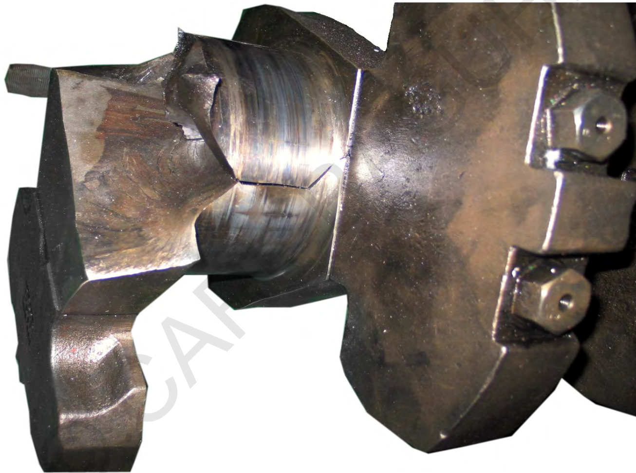
Kurbelwellenschäden an mittelschnell laufenden Dieselmotoren
